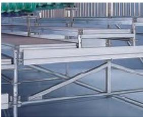
La viga EV104 (2,07 m.) soporta 7,5 kN/m<sup>2</sup>. Para la viga EV86 (2,57 m.) la carga admisible es de 5,0 kN/m<sup>2</sup> y con refuerzos triangulares alcanza los 7,5 kN/m<sup>2</sup>.
